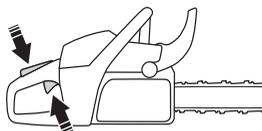
**Aclaración!** Para poner el freno de cadena en su posición inicial, mueva la protección contra reculadas hacia la empuñadura del mango. Ahora, la motosierra está lista para funcionar.
