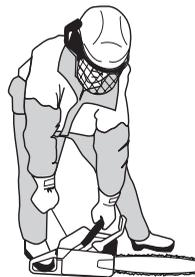
Cuando el motor encienda, oprima inmediatamente el estrangulador y repita los intentos de arranque hasta que el motor se ponga en marcha. Cuando arranque el motor,
