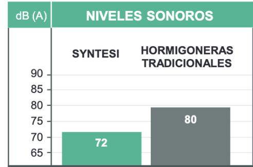
Nuestro sistema de transmisión directa, reduce de una forma importante la rumorosidad de nuestras hormigoneras, con respecto a las hormigoneras tradicionales de transmisión mediante corona dentada y piñón dentado.
