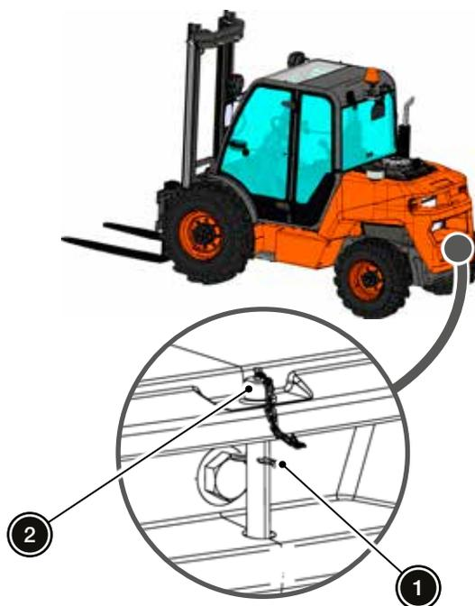
2. Colocar el pasador a través del contrapeso y el dispositivo de remolcado. Bloquear el pasador con el seguro.
