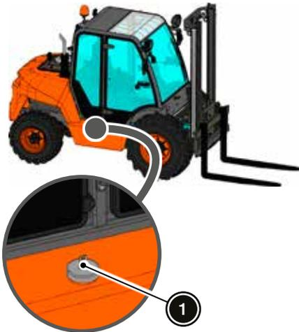
5. Limpiar la zona del tapón (1) del depósito de combustible para evitar que entre la suciedad acumulada, agua u otra sustancia durante el repostaje.
