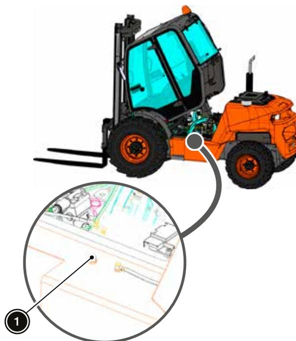
5. Limpiar la zona del tapón (1) del depósito de aceite hidráulico para evitar que entre la suciedad acumulada, agua u otra sustancia durante el rellenado.
