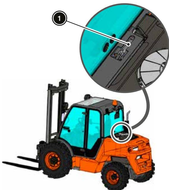
2. Levantar la cabina del operador.
